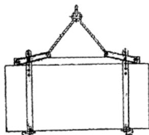
Строповка крупногабаритной плиты специальной траверсой
