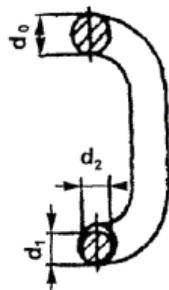
Рис. 2 . Уменьшение диаметра сечения звена цепи:
