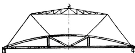
Строповка железобетонной фермы балансирующей траверсой
