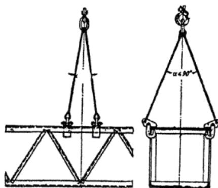
Схема строповки железобетонных изделий
