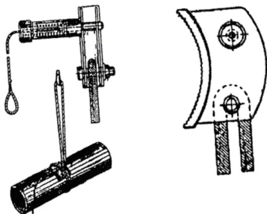
Строповка прямоугольной конструкции специальным стропом
