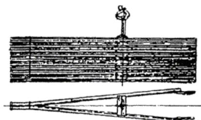
Строповка пирамидообразной конструкции высоковольтной опоры
