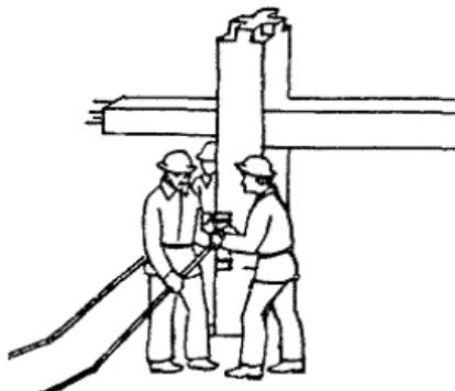
8 СНЯТИЕ ОПАЛУБКИ; 6 мин; Б1, Б2, Б3, Б4; гаечные ключи, молоток, зубило, щетка
