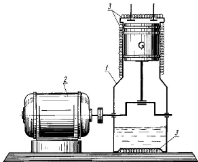
1 — двигатель; 2 — электромотор; 3 — электронагревательные элементы
