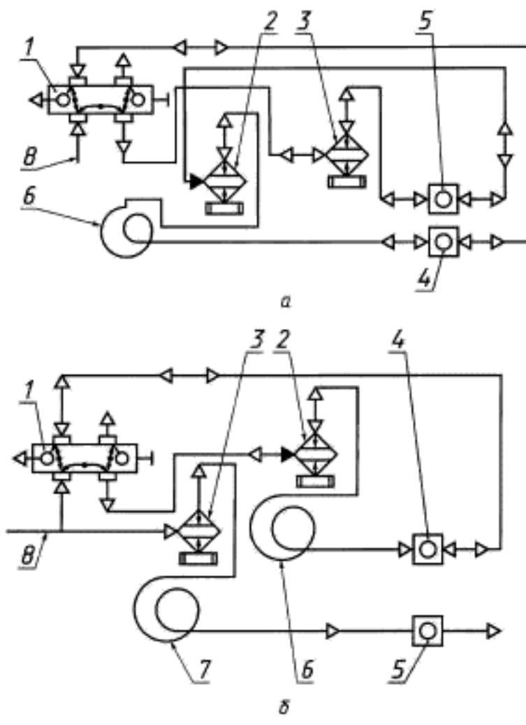
а — с регистрацией обратного пика; б — без регистрации обратного пика; 1 — кран-дозатор; 2 — испаритель первой колонки; 3 — испаритель второй колонки; 4 — детектор первой колонки; 5 — детектор второй колонки; 6 — первая колонка; 7 — вторая колонка; 8 — газ-носитель
