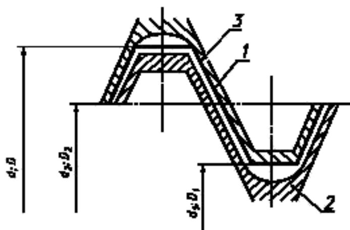
1 — поле допуска внутренней резьбы; 2 — поле допуска наружной резьбы; 3 —名义альный профиль;  $d_1, D_1$  —名义альный наружный диаметр;  $d_2, D_2$  —名义альный внутренний диаметр;  $d_1, D_1$  —名义альный средний диаметр
