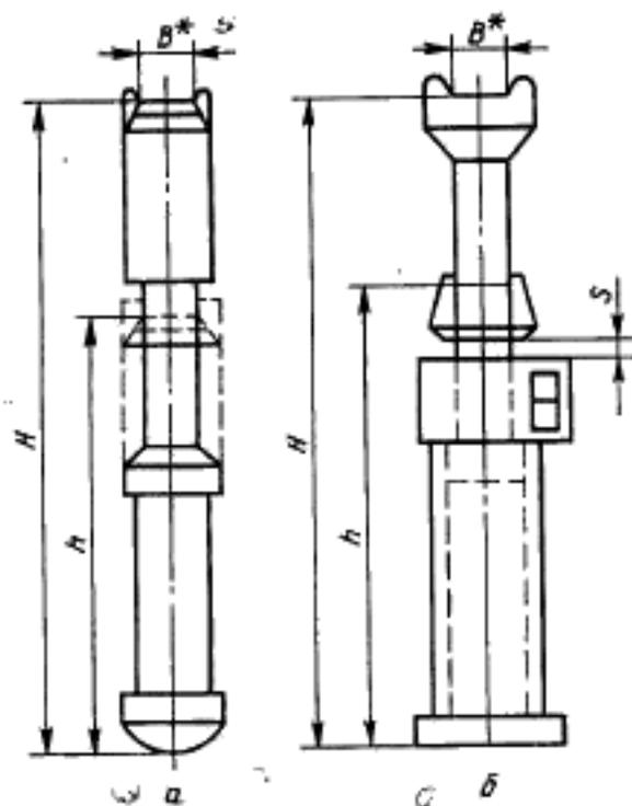
а — гидравлическая стойка; б — стойка трения
