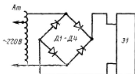
Д<sub>1</sub>—Д<sub>4</sub>—полупроводниковый диод КД202Р;
