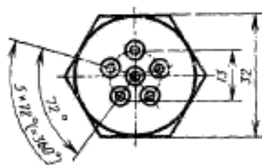
Расход воды 0,63 л/с Свободная длина труб 350 мм
