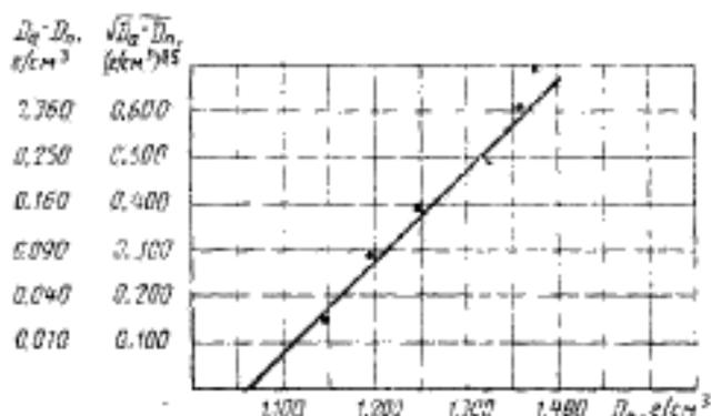
В высококонцентрированных суспензиях показатели упругости могут иметь преувеличенно большие значения (за счет тиксотропии). При обработке результатов допускается не принимать во внимание данные первых измерений упругости таких суспензий.
