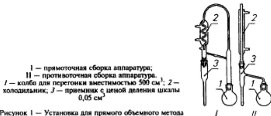
1 — прямоточная сборка аппаратура;
