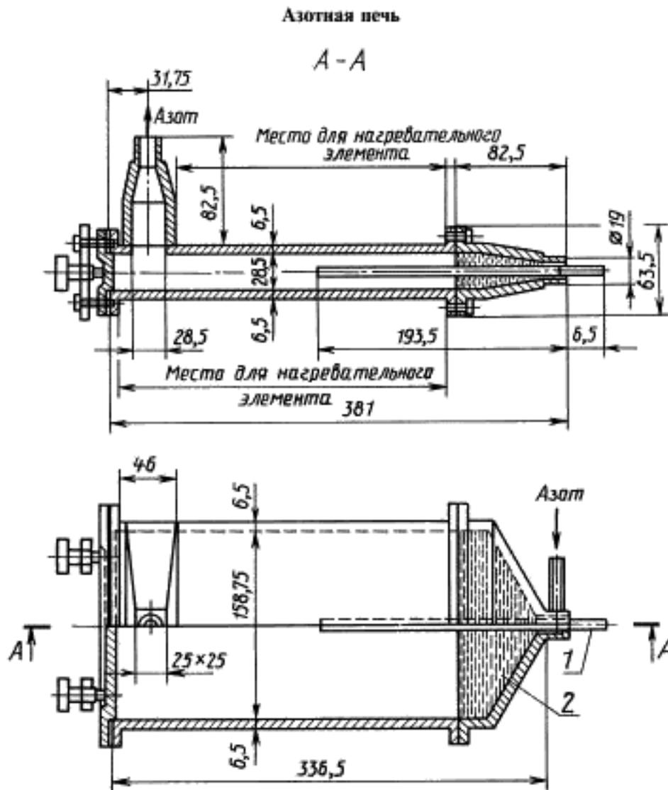
1 — трубка термометра; 2 — медная сетка (размер отверстий 0,25 мм)
