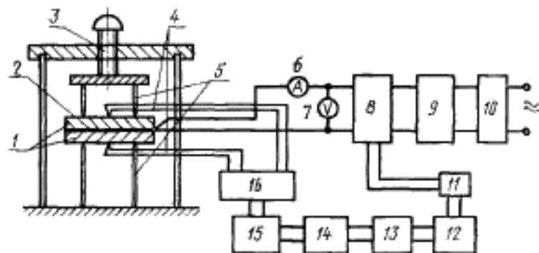
1—исследуемый образец; 2—нагреватель; 3—прижимной винт; 4—термопары; 5—угольчатые держатели; 6—миллиамперметр; 7—вольтметр; 8—электромагнитное реле; 9—генератор; 10—выпрямитель; 11—реле; 12—самописец электронный; 13—усилитель; 14—магазин сопротивлений; 15—потенциометр; 16—переключатель
