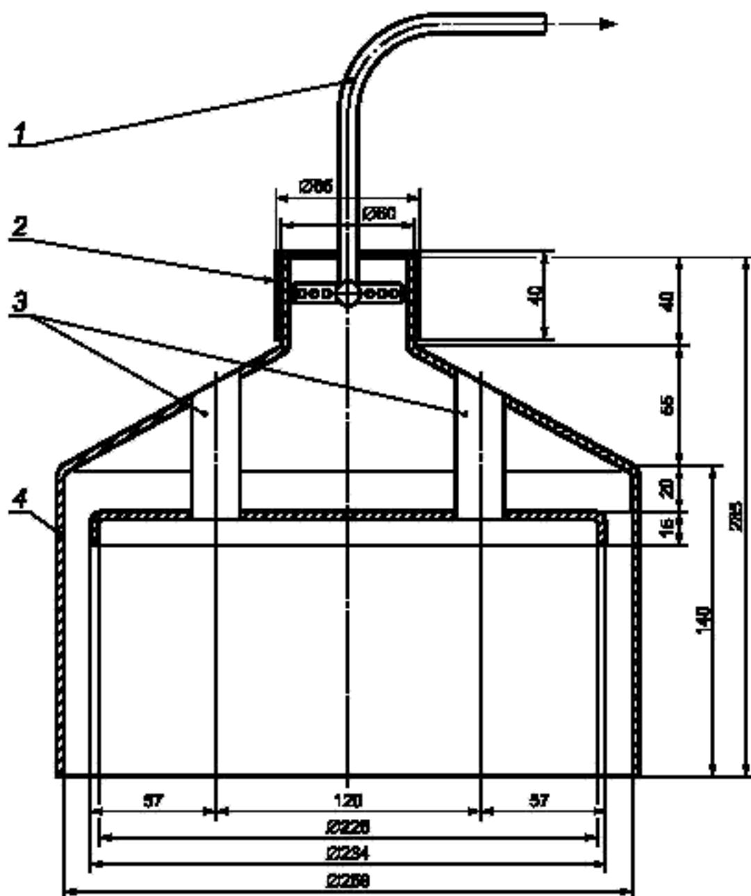
1 — медная трубка размером 8 × 1 мм для отвода продуктов сгорания к анализатору; 2 — заслонка;
