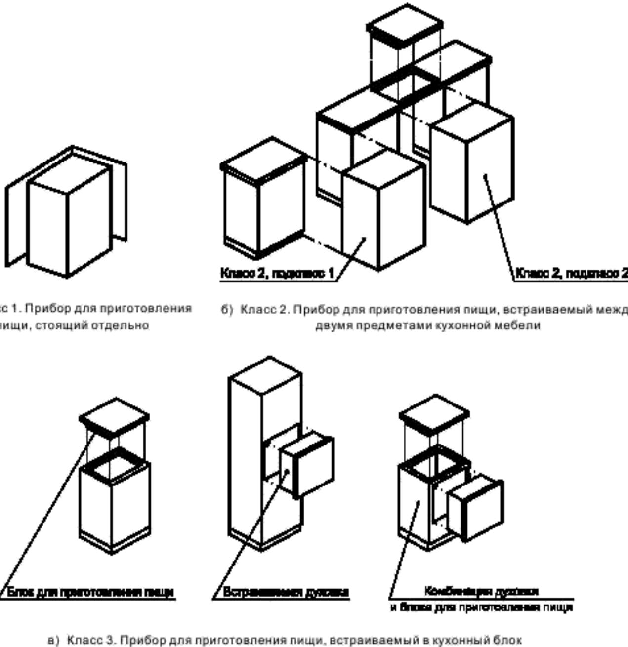
Рисунок 2 — Классификация приборов
