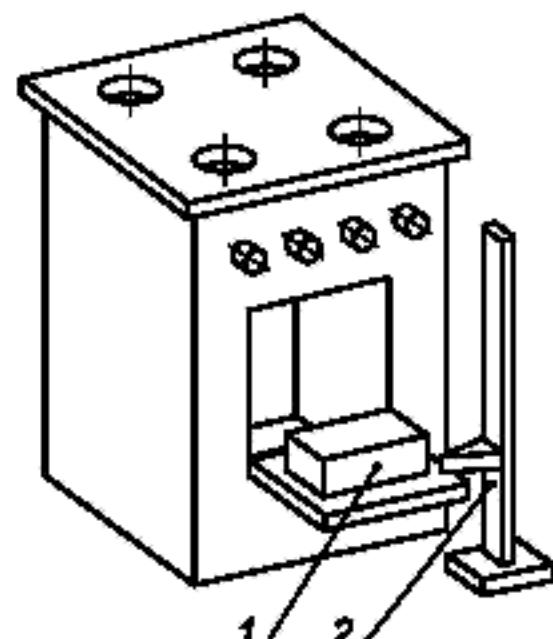
1 — испытательный груз; 2 — измерительное устройство
