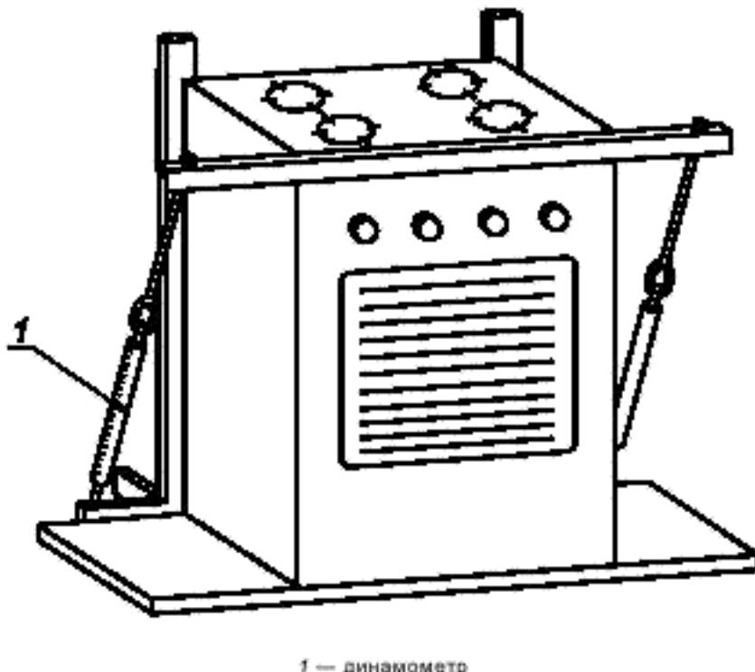
Рисунок 5 — Испытание корпуса прибора на прочность
