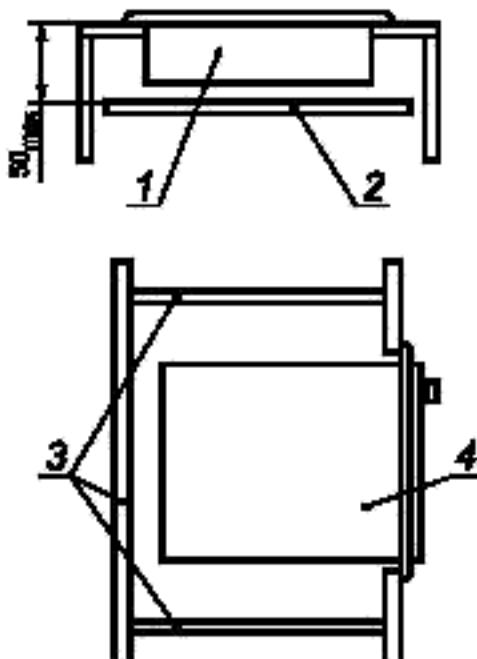
1 — блок для приготовления пищи; 2 — горизонтальная разделительная пластина (размеры — по указанию изготовителя);
