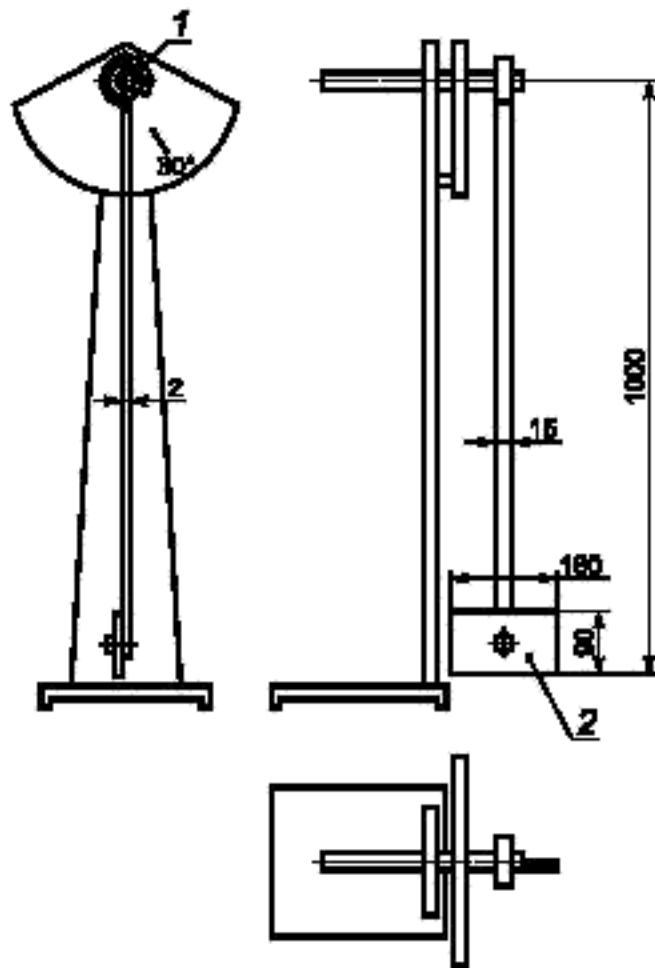
1 — подшипник; 2 — пластина из нержавеющей стали толщиной 2 мм
