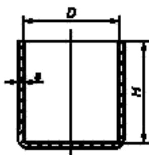
$D$  — внутренний диаметр, измеренный в верхней части;
