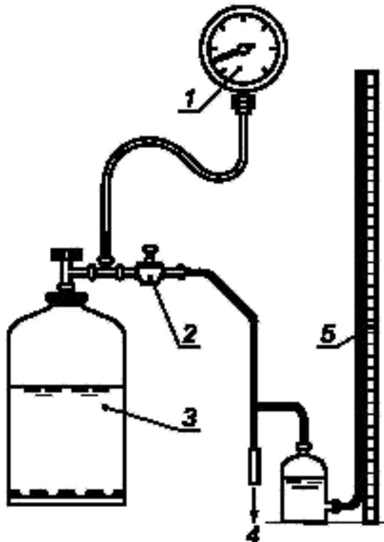
1 и 5 — манометры; 2 — регулятор давления;
