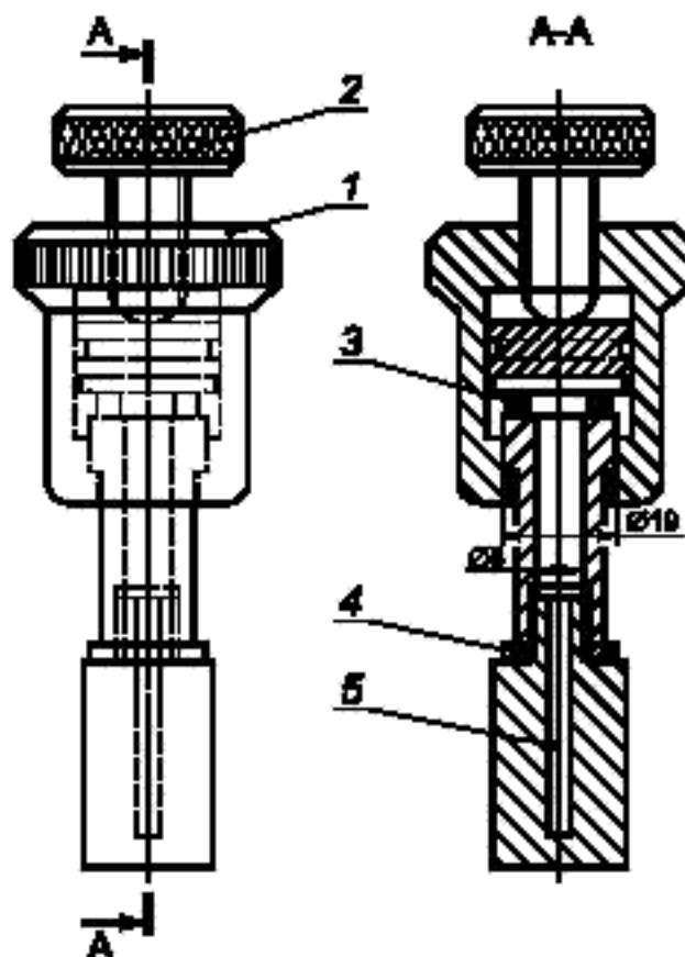
1 — установочная гайка; 2 — винт; 3 — образец; 4 — металлическая подкладная шайба; 5 — внутренний объем 5,5 см<sup>3</sup>
