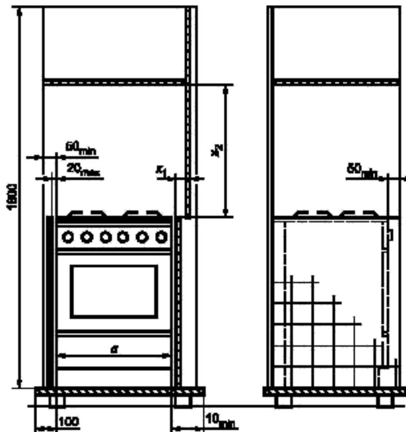
$a$  — ширина прибора;  $x_1$  — расстояние от боковой стенки прибора до дополнительной вертикальной стенки стендса,
