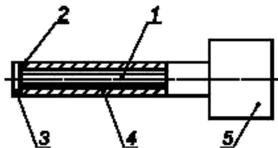
1 — проволоки термозлемента диаметром 0,3 мм (хромель-алюмель) общей длиной  $(1500 \pm 2)$  мм; 2 — kleящее средство; 3 — оцинкованный медный диск диаметром 5 мм, толщиной 0,5 мм; 4 — труба из керамики внутренним диаметром 3 мм, наружным диаметром 6 мм, в выдвинутом положении длиной  $(100 \pm 2)$  мм; 5 — ручка длиной  $(120 \pm 2)$  мм, наружным диаметром  $(25 \pm 2)$  мм
