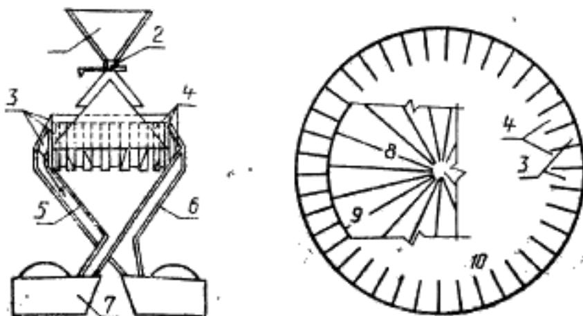
1 — загрузочная воронка; 2 — задвижка; 3 — емкости, открывающиеся во вмешанную воронку; 4 — каналы, отводящие поток во внутреннюю воронку; 5 — внутренняя воронка; 6 — внешняя воронка; 7 — приемник; 8 — основание конуса; 9 — вершина конуса; 10 — каналы, соединенные ниже основания конуса
