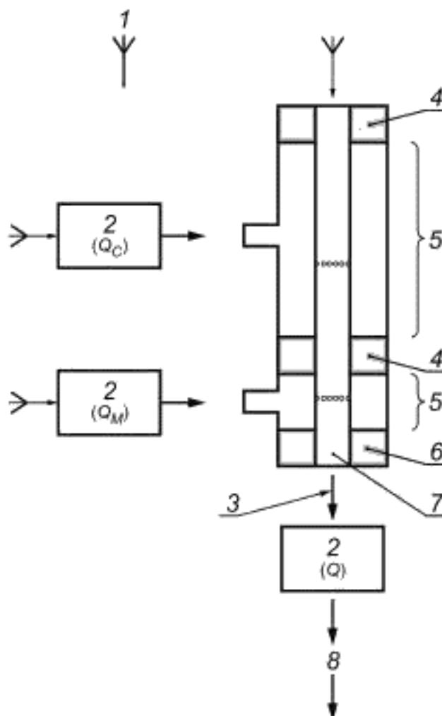
1 — атмосфера в соответствии с ГОСТ Р ИСО 3402; 2 — прибор для измерения объемного потока; 3 — перепад давления ( $\Delta P_z$ ); 4 — разделятельные уплотнения; 5 — вентиляционная камера; 6 — фиксированное удерживающее уплотнение; 7 — выходной конец калибра вентиляции; 8 — общий поток пропускаемого воздуха
