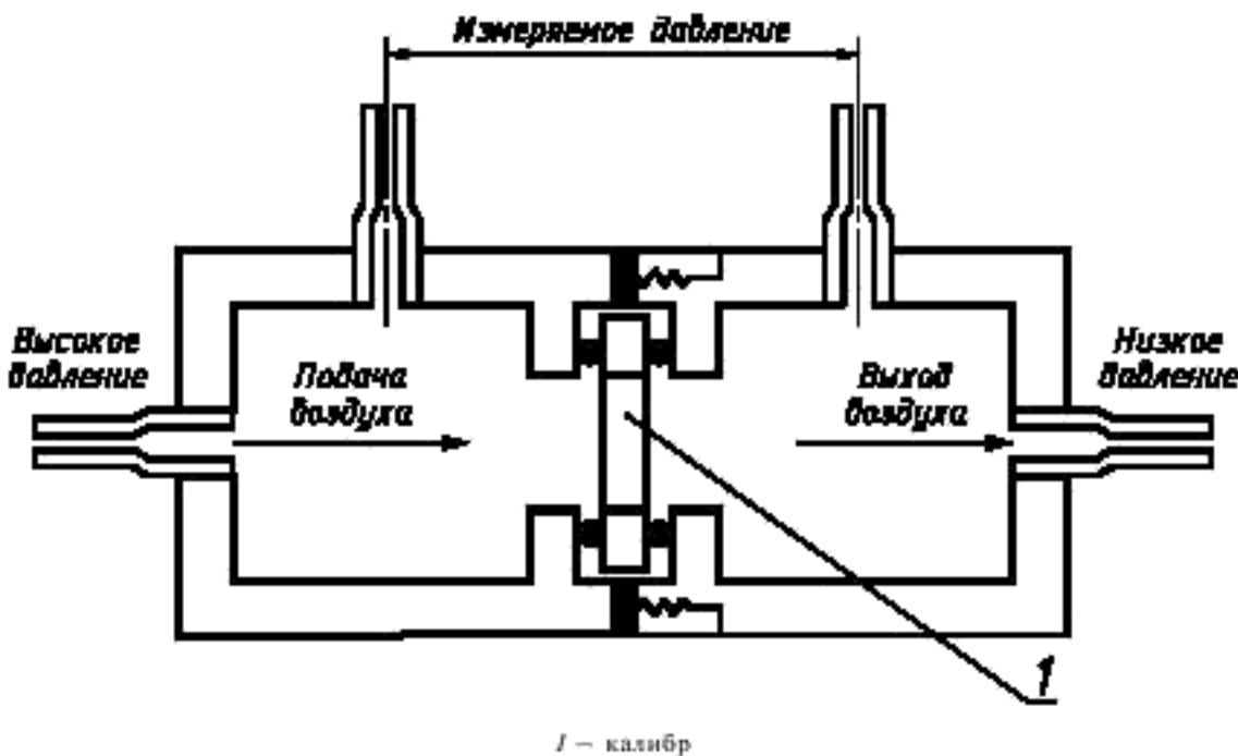
Рисунок В.1 — Схема прибора для калибровки калибров
