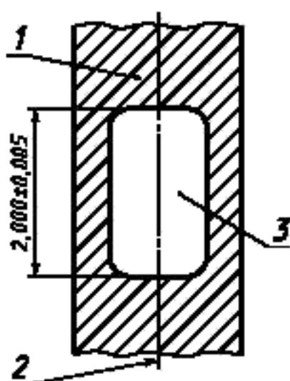
1 — испытуемый образец; 2 — осевая линия образца; 3 — измеряемая поверхность площадки экспериментального образца в держателе
