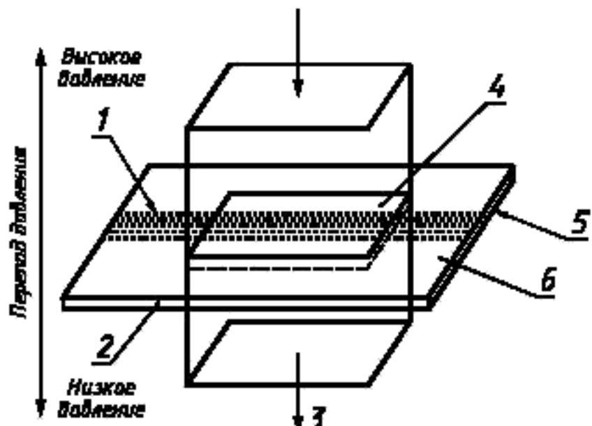
1 — перфорация (если имеется); 2 — опытный образец; 3 — направление воздушного потока; 4 — испытуемая поверхность образца площадью 2 см<sup>2</sup>; 5 — нижняя поверхность; 6 — верхняя поверхность
