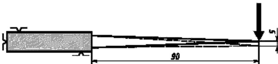
Рисунок 6 — Схема проведения испытаний на прочность и упругость разделочных и шкуросъемных ножей.
