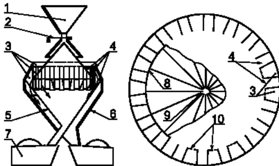
1 — бункер; 2 — задвижка; 3 — пространство, которое выходит по внешнюю воронку; 4 — трубы, выходящие во внутреннюю воронку; 5 — внутренняя воронка; 6 — внешняя воронка; 7 — приемник; 8 — основание конуса; 9 — вершина конуса; 10 — трубы, расположенные ниже основания конуса
