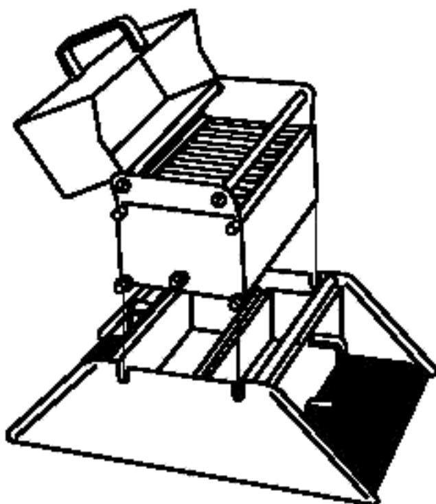
Рисунок А.2 — Множественно-шелевой делитель с системой сортировки
