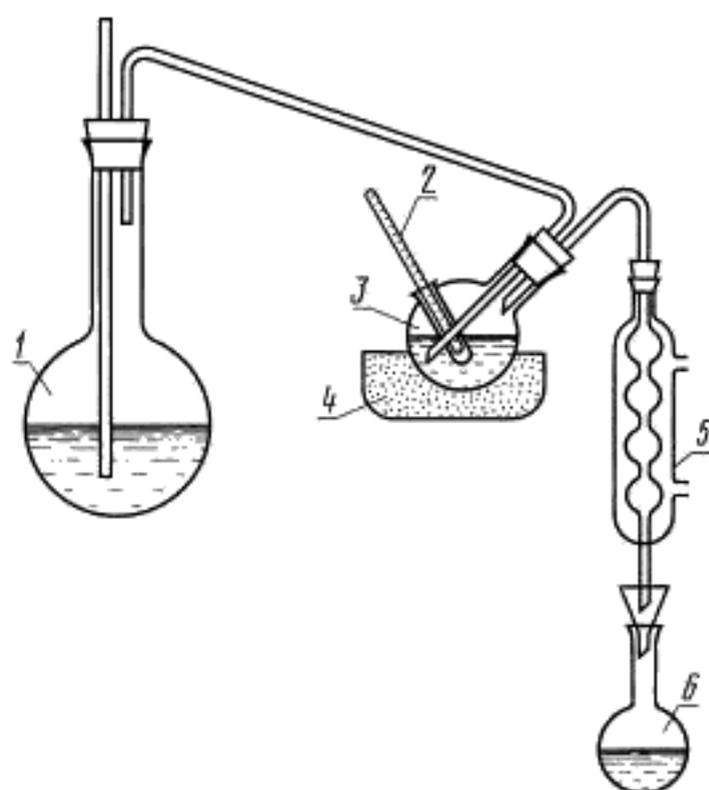
1 — парообразователь — колба вместимостью 750—2000 см<sup>3</sup>, 2 — термометр; 3 — реакционная круглодонная короткогорлая колба вместимостью 250 см<sup>3</sup> из термостойкого стекла или кварца с карманом для термометра; 4 — колбонагреватель, соединенный с реле; 5 — шариковый холодильник; 6 — приемник для конденсата — мерная колба вместимостью 250 см<sup>3</sup>
