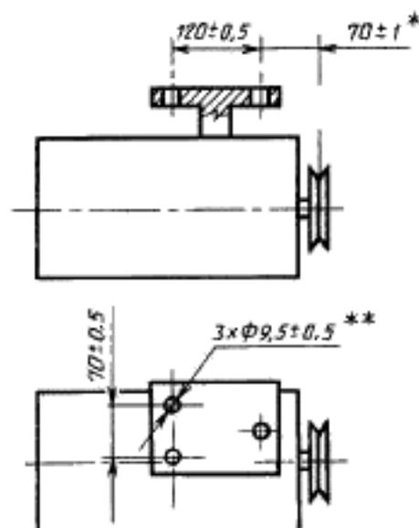
\* Размер действителен при включенной муфте
