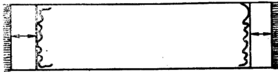
За результат принимают максимальную разницу расстояний на смежных или параллельных сторонах изделия.
