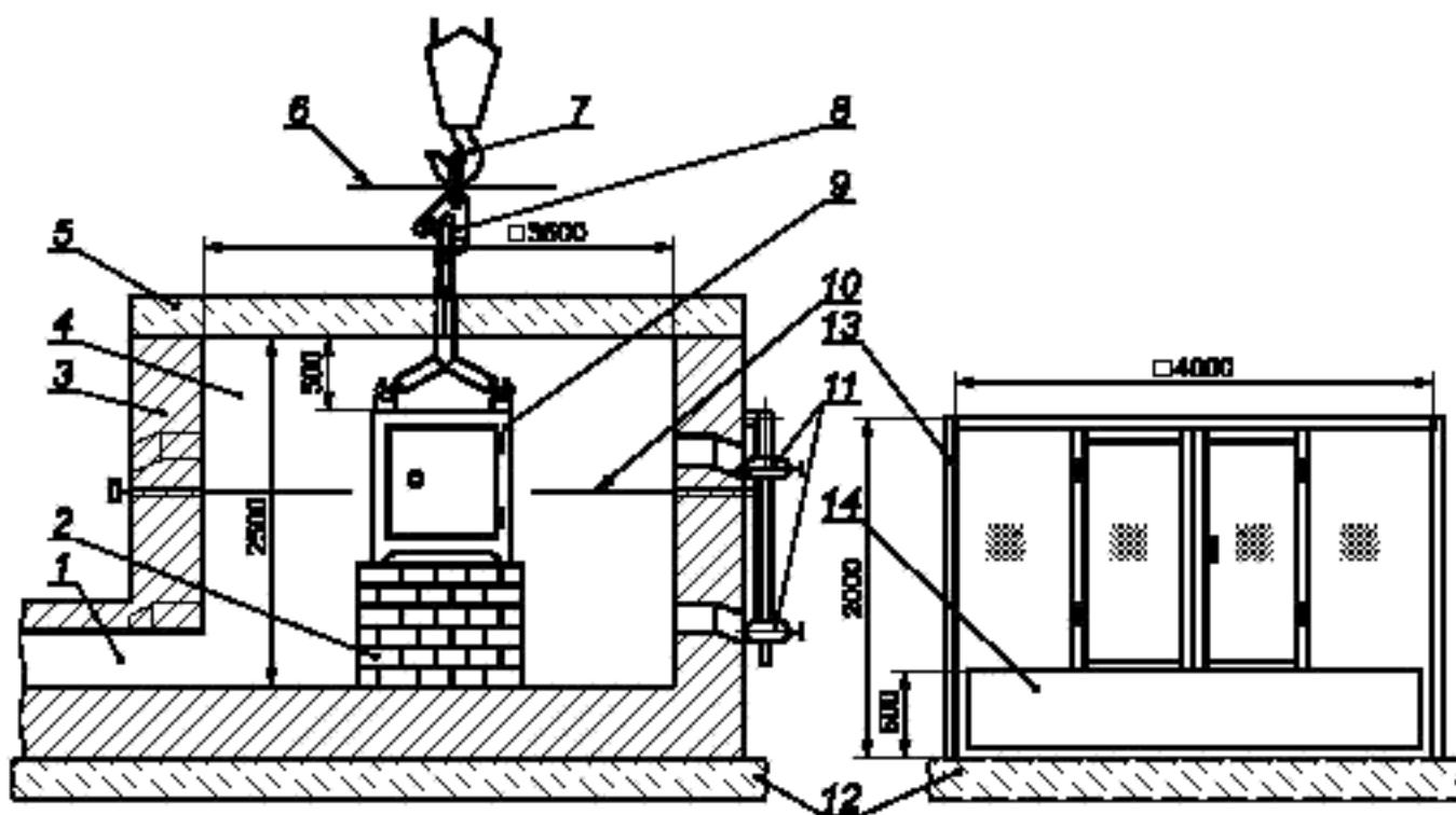
1 — дымовая труба; 2 — опора образца; 3 — кладка печи; 4 — огневая камера; 5 — перекрытие печи; 6 — защитный экран;
