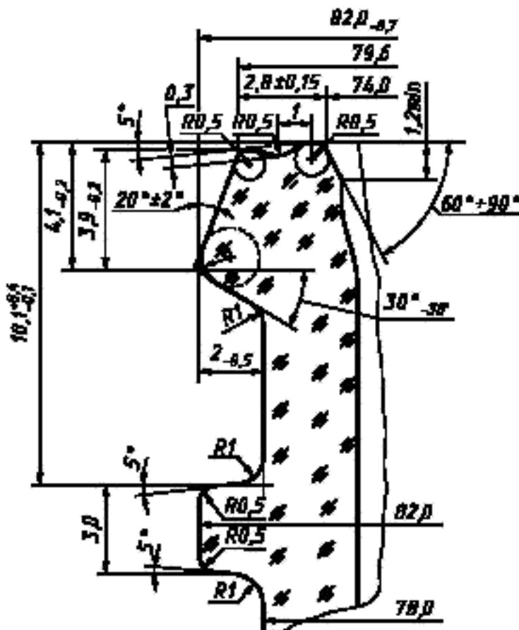
Контролируемый диаметр венчика горловины —  $82,0_{-0,7}$ , остальные размеры даны для изготовления формокомплекта.
