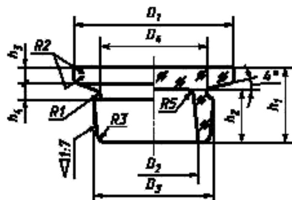
Контролируемый размер пробки, мм, —  $D_3$ .
