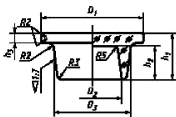
Контролируемый размер пробки, мм, —  $D_3$ .
