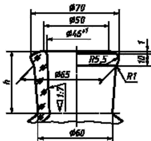
Контролируемый размер венчика горловины, мм, —  $\text{Ø} 46^{+1}$ .
