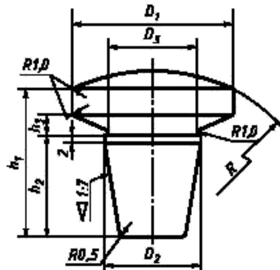
Контролируемый размер пробки, мм, —  $D_2$ .
