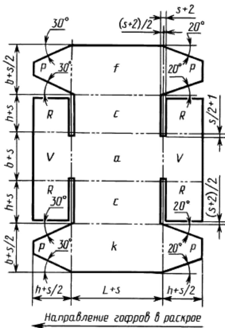
*a* — дно ящика; *c* — боковые стенки ящика; *b* — внутренняя ширина ящика, мм; *f* — верхний клапан ящика; *k* — крышка ящика, *h* — внутренняя высота ящика, мм; *R*, *p* — клапаны ящика; *l* — внутренняя длина ящика, мм; *s* — толщина картона, мм; *v* — торцевые стенки ящика
