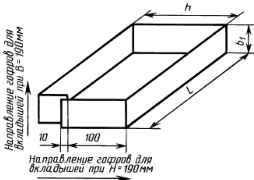
$L$  — внутренняя длина ящика, мм;  $b_1$  — внутренняя ширина ящика, мм;  $h$  — внутренняя высота ящика, мм
