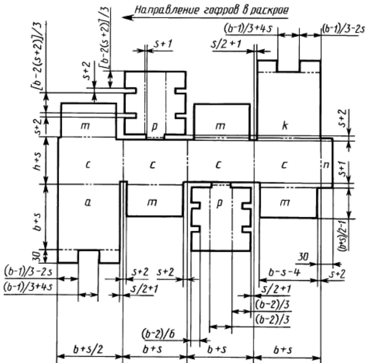
*a* — дно ящика; *b* — внутренняя ширина (длина) ящика, мм; *c* — боковые стенки ящика; *k* — крышки ящика; *h* — внутренняя высота ящика, мм; *л* — соединительный клапан каркаса ящика; *т* — толщина картоня, мм; *m, p* — клапаны ящика
