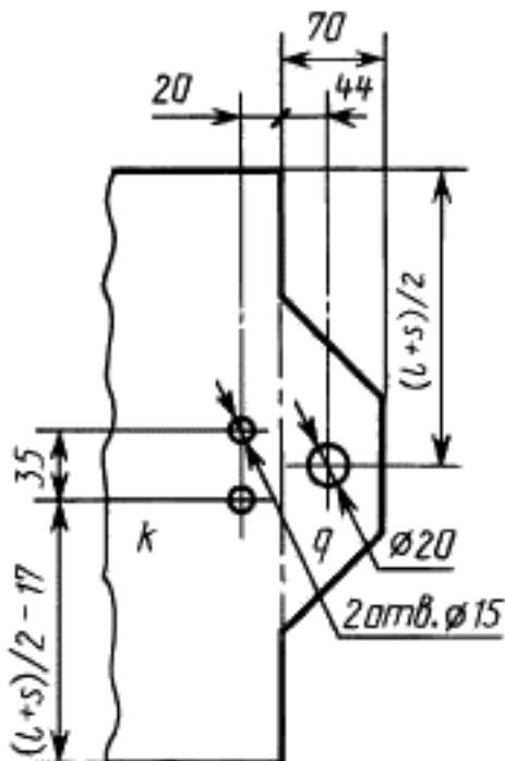
*k* — крышка ящика; *l* — внутренняя длина ящика, мм; *q* — соединительный клапан ящика; *z* — толщина гофрированного картона, мм
