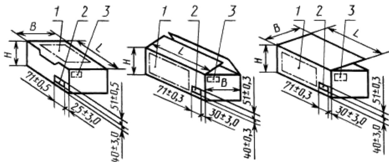
*l* — зона для нанесения маркировки; *2* — рамка прямоугольная (только для ящиков по табл. 1); *3* — зона для маркировки, характеризующей тару; *L* — длина ящика, мм; *B* — ширина ящика, мм; *H* — высота ящика, мм
