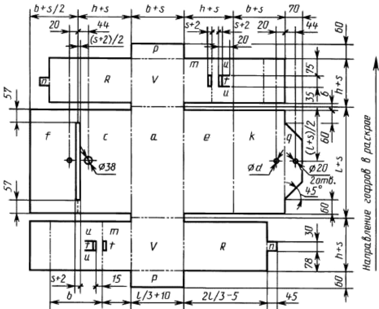
*a* — дно ящика; *b* — внутренняя ширина ящика, мм; *c*, *e* — боковые стенки ящика; *d* — диаметр отверстия, мм; *f* — верхний клапан ящика; *g* — крышка ящика; *h* — внутренняя высота ящика, мм; *p*, *m*, *R* — клапан ящика; *I* — внутренняя длина ящика, мм; *l* — соединительный клапан каркаса ящика; *x* — толщина гофрированного картона, мм; *t* — прорезь для соединительного клапана ящика; *z* — просечки замкового элемента; *v* — торцевые стенки ящика; *q* — соединительный клапан ящика.
