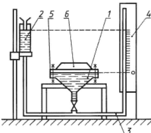
1 — камера давления; 2 — сосуд для испытательной жидкости; 3 — резиновая трубка; 4 — манометр;
