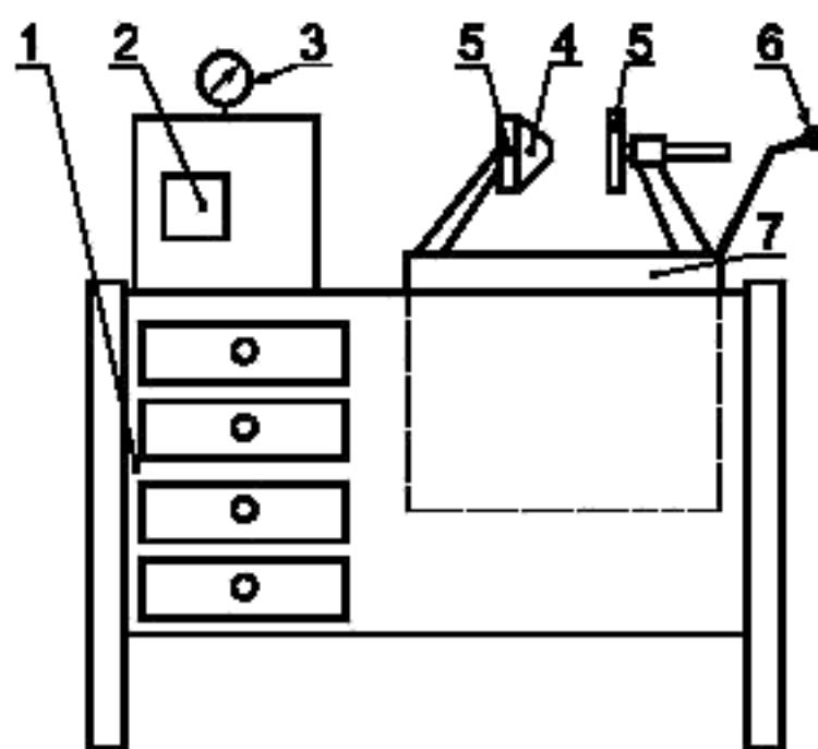
1 — рабочий стол; 2 — пульт управления; 3 — манометр; 4 — уплотнительная прокладка; 5 — клемшины (упоры) для зажима испытуемого образца тары; 6 — рукоятка подъема клемшней; 7 — испытательная пинза
