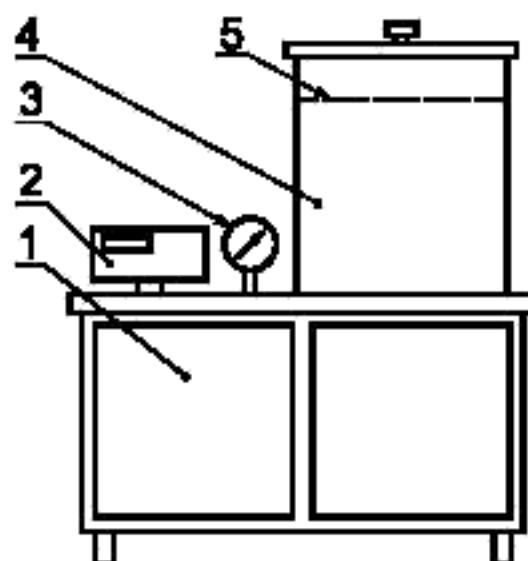
1 — рабочий стол; 2 — пульт управления; 3 — манометр; 4 — вакуумная камера; 5 — съемный фиксатор тары
