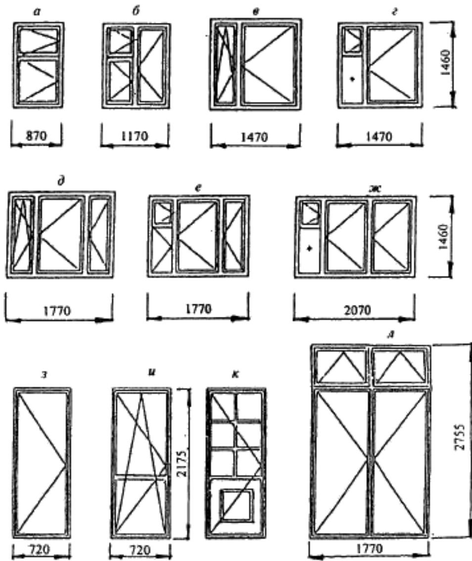
**а, б, в, г, д, е, ж** — примеры конструкций оконных блоков 15М по высоте; **з, и** — конструкции однопольных балконных дверных блоков размером 22-7; **к** — то же, по индивидуальному заказу: с горбыльковым переплетом и глухой филейкой; **л** — примеры конструкции двупольного балконного дверного блока с двойной фрамугой для общественных зданий размером, 28-18
