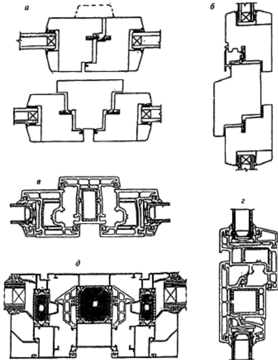
*а — вертикальные безимпостный (штуплевой) и импостный притворы деревянного оконного блока; б — горизонтальный импостный притвор деревянного оконного блока; в — импостный притвор оконного блока из ПВХ профилей; г — узел импостного соединения открывющейся створки и остекленной коробки; д — импостный притвор оконного блока из алюминиевого сплава*
