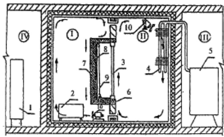
I — теплое отделение камеры; II — холодное отделение камеры; III — машинный зал; IV — помещение с измерительной аппаратурой; 1 — система автоматического сбора данных; 2 — нагревательные приборы; 3 — испытываемый оконный блок; 4 — испаритель; 5 — холодильная установка; 6 — теплоизоляционный слой по периметру проема; 7 — калориметр (утепленная приставная камера); 8 — металлическое отражательное покрытие; 9 — спираль нагрева, равномерно распределенная по площади калориметра; 10 — вентилятор
