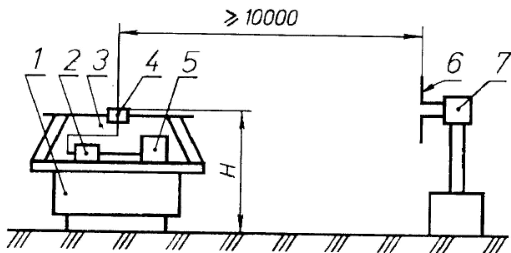
1 — поворотное устройство; 2 — измеритель КСВН; 3 — фидер питания исследуемой антенны; 4 — эталонный штырь или исследуемая антenna; 5 — генератор высокой частоты; 6 — приемная антenna; 7 — измеритель напряженности поля.
