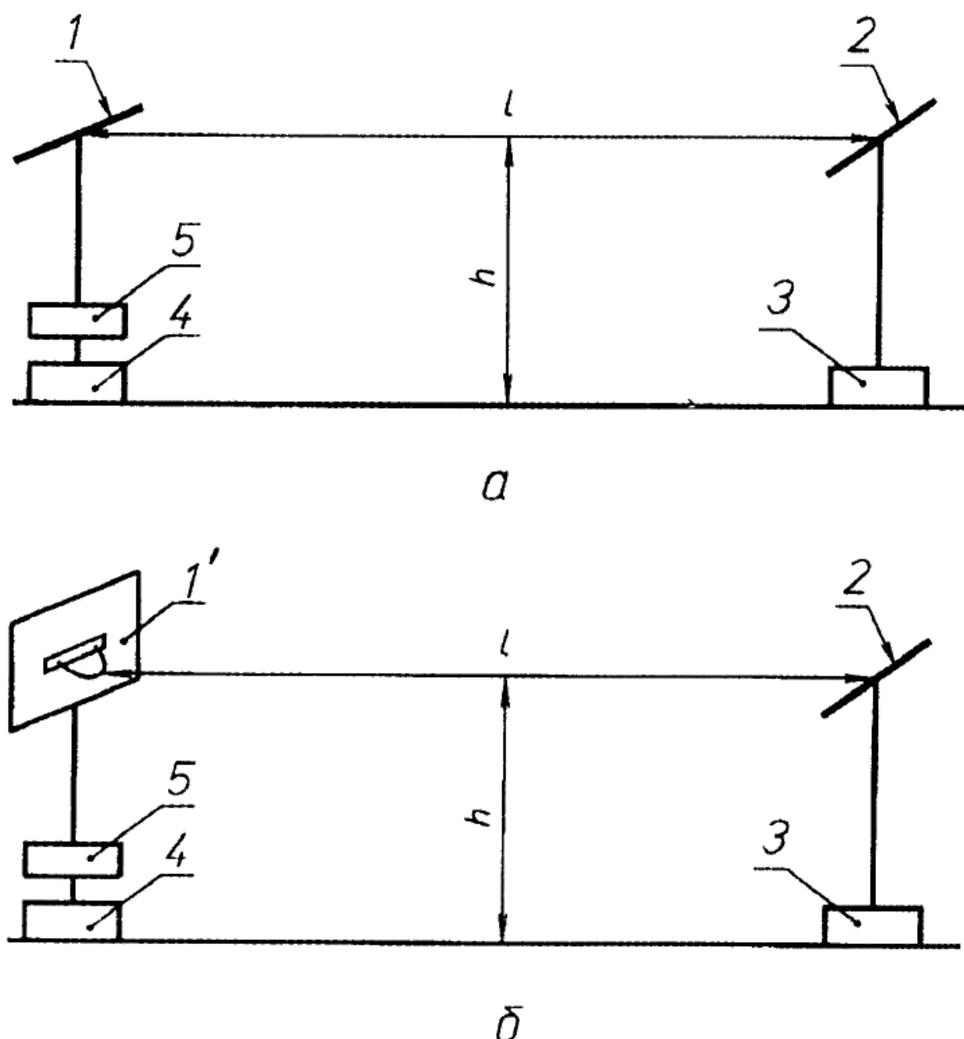
1 — антенна измерительная LPA-1; 1' — измеряемая антenna, размещенная на макете или на металлическом листе; 2 — облучающая антenna; 3 — встроенный генератор высокочастотных сигналов селективного микровольтметра SMV-8.5; 4 — микровольтметр селективный SMV-8.5; 5 — стенд поворотный
