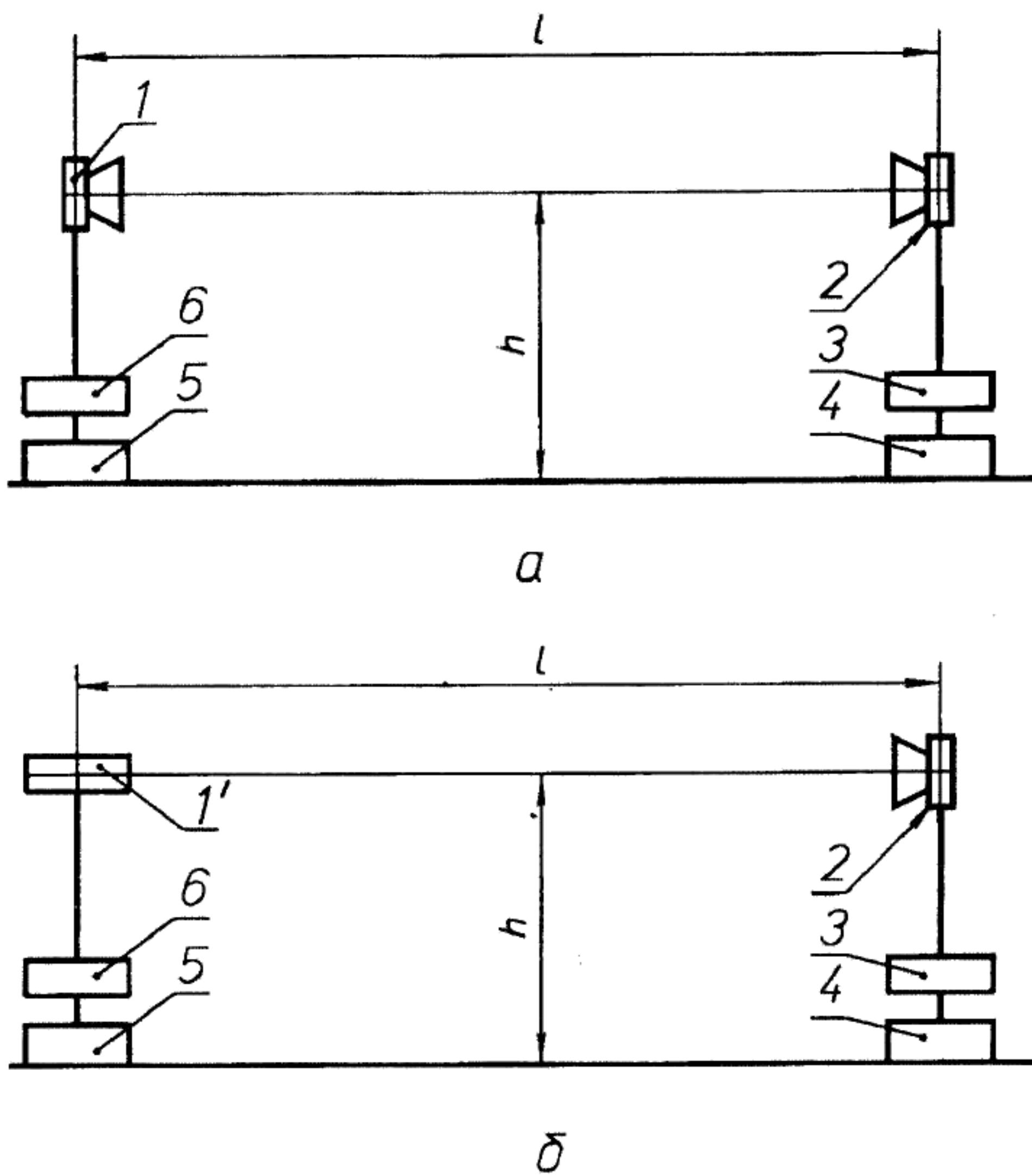
1 — измерительная антenna; 1' — измеряемая антenna; 2 — антenna облучающая (вспомогательная); 3 — аттенюатор; 4 — генератор высокочастотных сигналов; 5 — устройство приемное с индикатором; 6 — стенд поворотный
