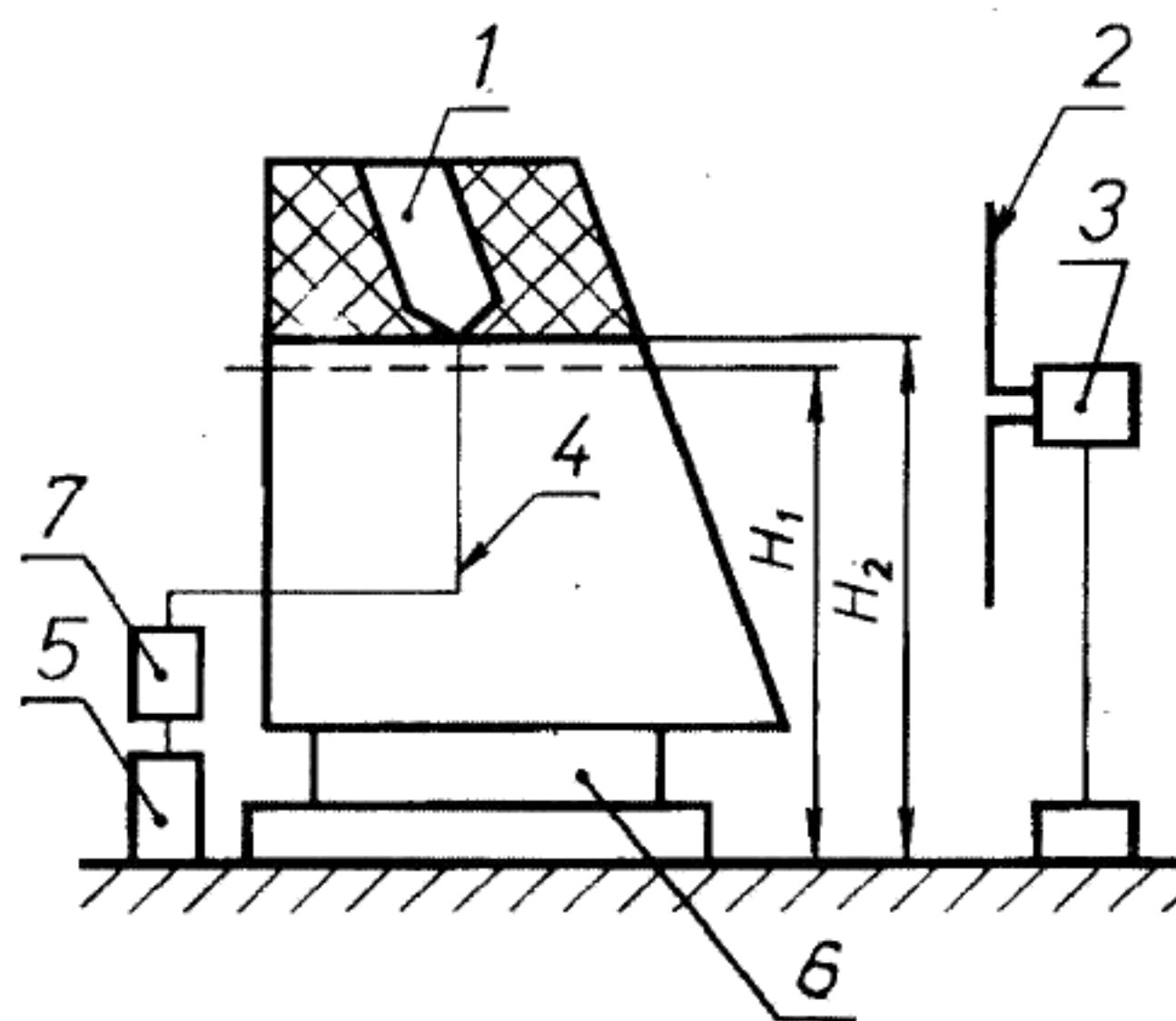
1 — исследуемая или эталонная антenna; 2 — соединительный фидер; 3 — селективный микровольтметр; 4 — приемная антenna; 5 — измеритель КСВ; 6 — поворотное устройство; 7 — генератор высокочастотных сигналов
