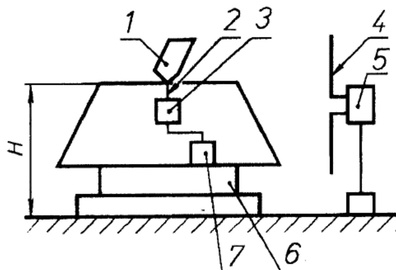
1 — исследуемая или эталонная антенна; 2 — соединительный фидер; 3 — измеритель КСВ; 4 — приемная антенна; 5 — selectiveный микровольтметр; 6 — поворотное устройство; 7 — генератор высокочастотных сигналов
