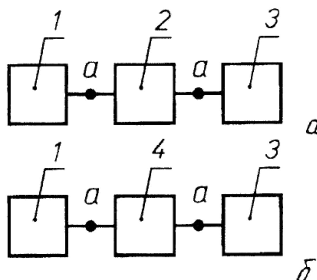
1 — генератор высокочастотных сигналов (встроенный генератор селективного макровольтметра SMV-8,5); 2 — измерительный кабель; 3 — приемное устройство с индикатором (SMV-8,5); 4 — измеряемый фидерный тракт
