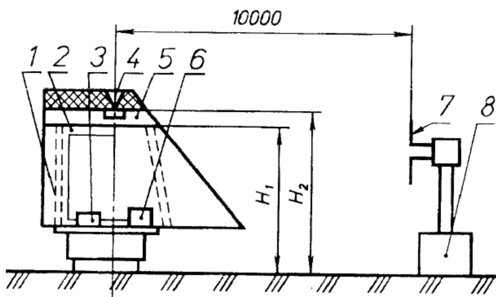
1 — поворотное устройство; 2 — фидер питания исследуемой антенны; 3 — измеритель КСВ; 4 — исследуемая антenna; 5 — диск с эталонной антенной; 6 — генератор высокой частоты; 7 — приемная антenna. 8 — измеритель напряженности поля.
