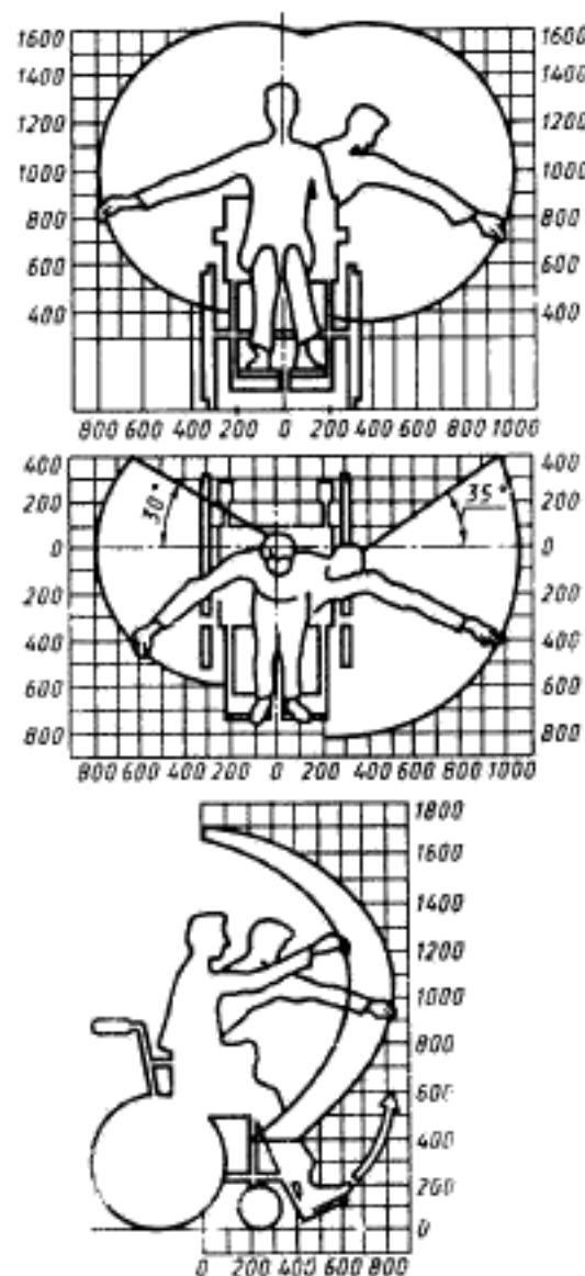
Рисунок Г 1 – Зона досягаемости для мужчин
