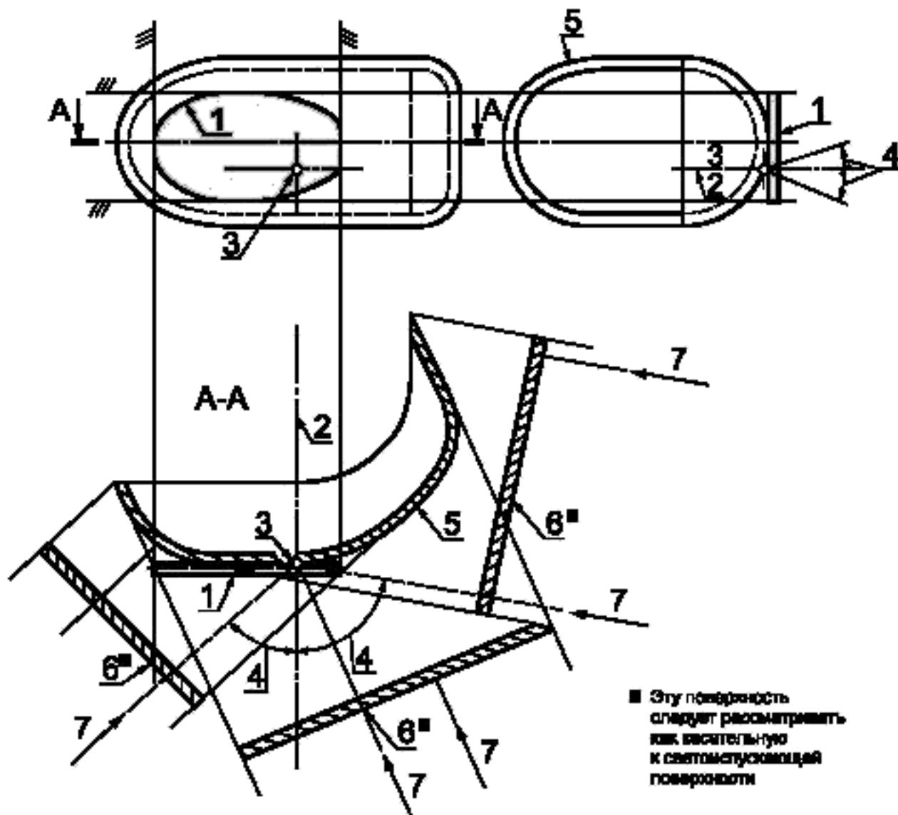
1 — освещаемая поверхность; 2 — исходная ось, 3 — исходный центр; 4 — угол геометрической видимости; 5 — светонапускающая поверхность; 6 — видимая поверхность; 7 — направление наблюдения
