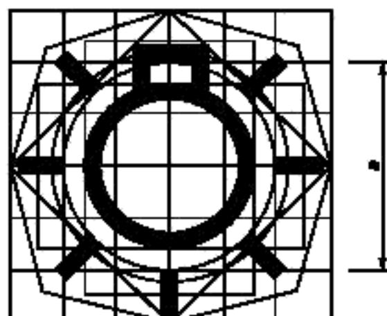
Рисунок 4.16б — Выключатель основных огней
