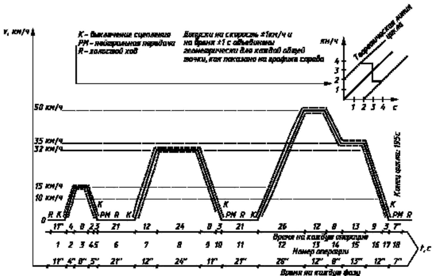
Рисунок Г.1 — Рабочий цикл при испытании типа I бензиновых двигателей
