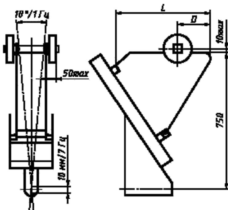
Рисунок 3 — Динамические испытания
