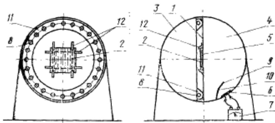
1 — диафрагма; 2 — образец, 3, 4 — полусфера диффузометра, 5 — отверстие в диафрагме; 6 — фотоэлемент; 7 — люксметр; 8 — источники света; 9 — щель, предохраняющая фотоэлемент от попадания ярких лучей источника света; 10 — кронштейн экрана, 11 — рефлектор; 12 — устройства для крепления образца в рабочем положении
