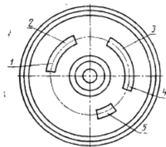
1 — условный номер предприятия-изготовителя черновой оси и две последние цифры года изготовления; 2 — условный номер предприятия-изготовителя оси; 3 — порядковый номер оси по системе нумерации предприятия-изготовителя; 4 — номер плавки; 5 — клеймо отдела технического контроля или государственной приемки (при наличии ее на предприятии)
