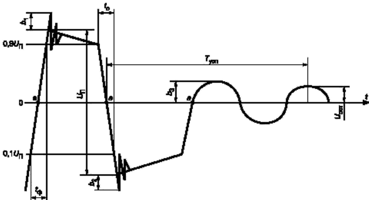
$t_{\phi}$  — длительность фронта сигнала;  $t_c$  — длительность спада сигнала;  $b_1, b_2, b_3$  — выбросы на вершине сигнала и колебания его амплитуды;  $U_{\Pi}$  — размах сигнала;  $T_{usn}$  — время успокоения линии;  $U_{ost}$  — амплитуда остаточного напряжения;  $a$  — точка перехода сигнала через нулевой уровень (нуль-переход)
