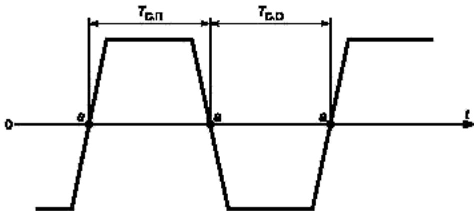
$T_{C,п}$  — длительность положительной полуволны сигнала;  $T_{C,0}$  — длительность отрицательной полуволны сигнала;
