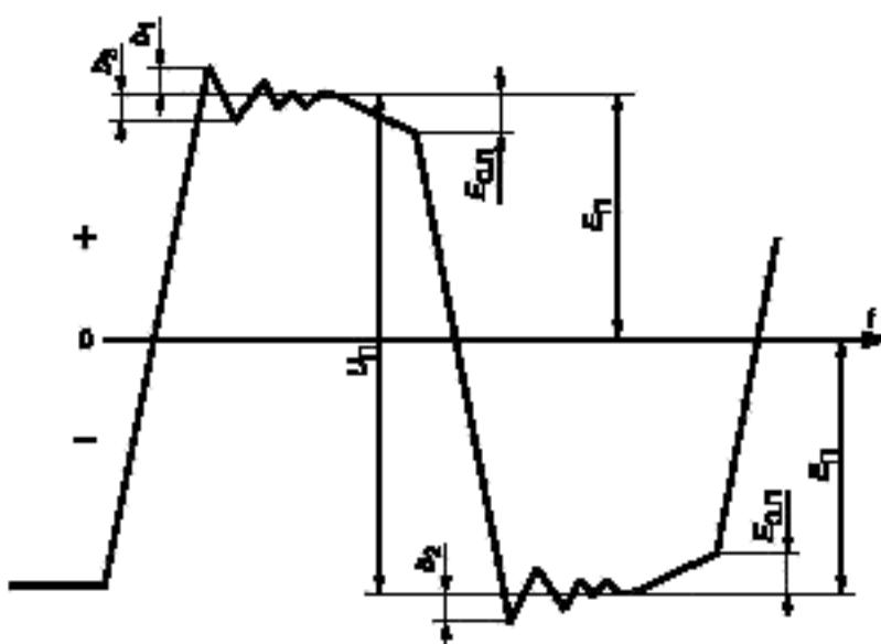
$U_{\Pi}$  — размах сигнала;  $E_{C,\Pi}$  — спад сигнала;  $E_{\Pi}$  — амплитуда сигнала;  $b_1$ ,  $b_2$ ,  $b_3$  — выбросы и колебания сигнала
