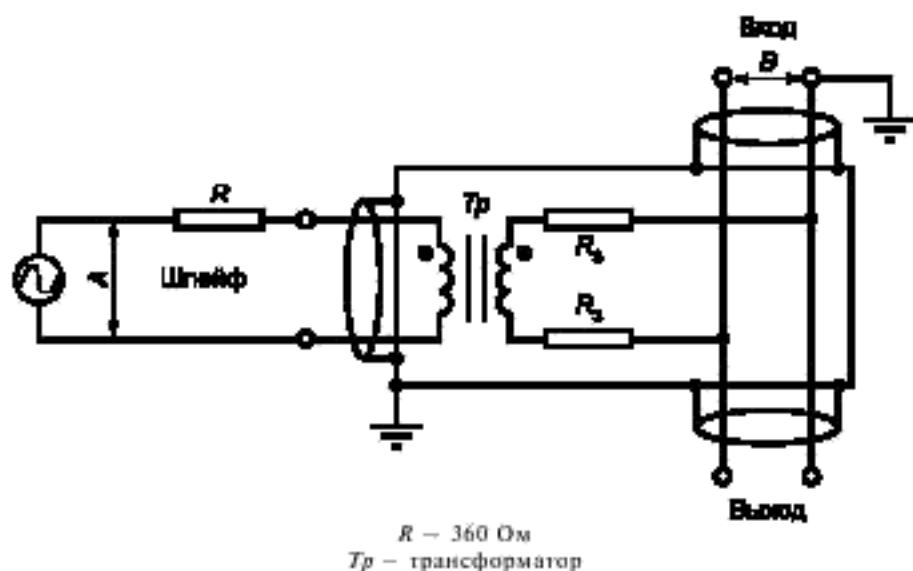
Рисунок 3 — Схема измерения выходного сигнала
