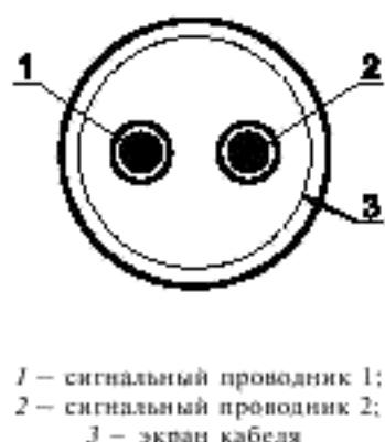
Рисунок 10 — Проводники кабеля (витой пары)
