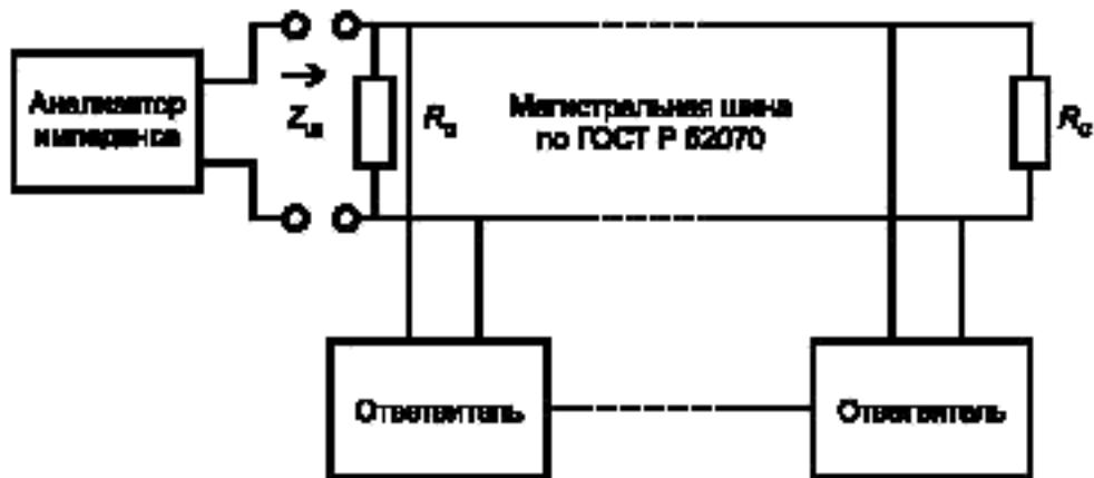
Рисунок 2 — Измерение импеданса магистральной шины
