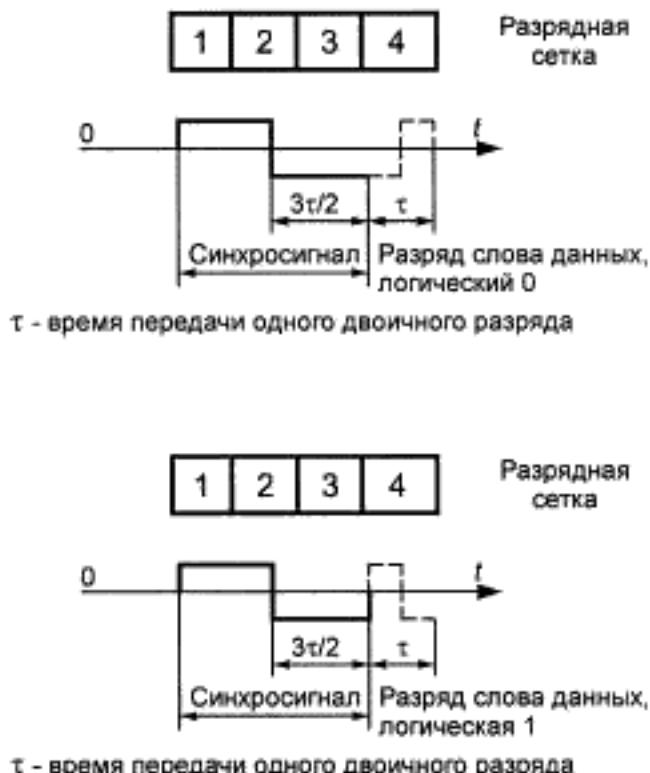
Рисунок 4 — Синхросигнал командного и ответного слов
