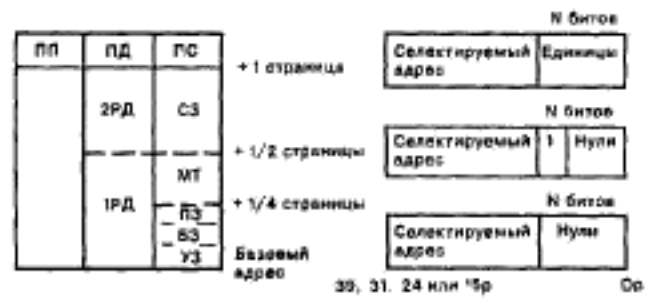
Рисунок Б.10 — Расположение регистров в зоне ВА модуля
