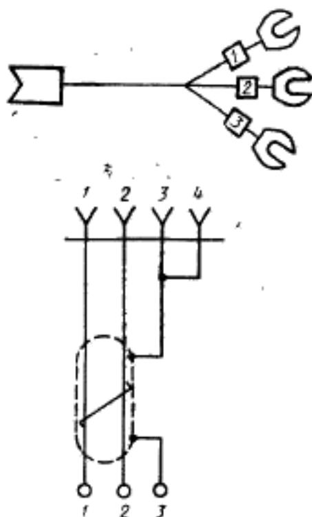
1 — первый сигнальный провод; 2 — второй сигнальный провод; 3 (4) — экран для объединения корпусов устройств комплекса
