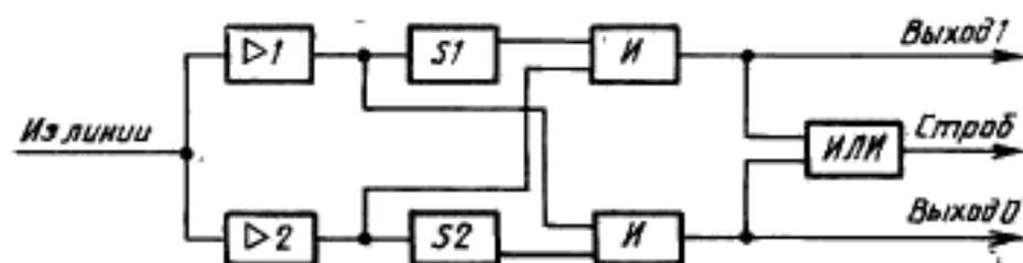
*Д1* — усилитель положительных импульсов; *Д2* — усилитель отрицательных импульсов;
