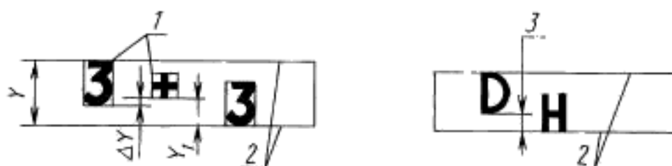
1 – оттиски в номинальном положении; 2 – границы строки; 3 – невыравнивание оттисков
