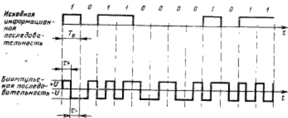
$\tau_+$  — длительность положительного импульса бимпульса;  $\tau_-$  — длительность отрицательного импульса бимпульса;  $\tau_+ + \tau_- = T_0/s$ , где  $T_0$  — единичный интервал;  $+V$ ,  $-V$  — амплитуда соответственно положительных и отрицательных импульсов бимпульсного сигнала.
