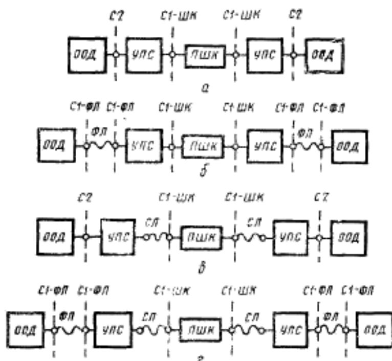
а—УПС сопрягается с ООД по цепям стыка  $C_2$  и с ПШК по цепям стыка  $C_1$  ( $C_1$ - $W_K$ ) при непосредственном сопряжении УПС с ПШК; б—УПС сопрягается с ООД по цепям стыка  $C_1$ - $FL$  при управлении от ООД и с ПШК по цепям стыка  $C_1$ - $W_K$ ; в—УПС сопрягается с ООД по цепям стыка  $C_2$  и с ПШК с помощью  $C_1$ - $L$ ; г—УПС сопрягается с ООД по стыку  $C_1$ - $FL$  и с ПШК с помощью  $C_1$ - $L$ .
