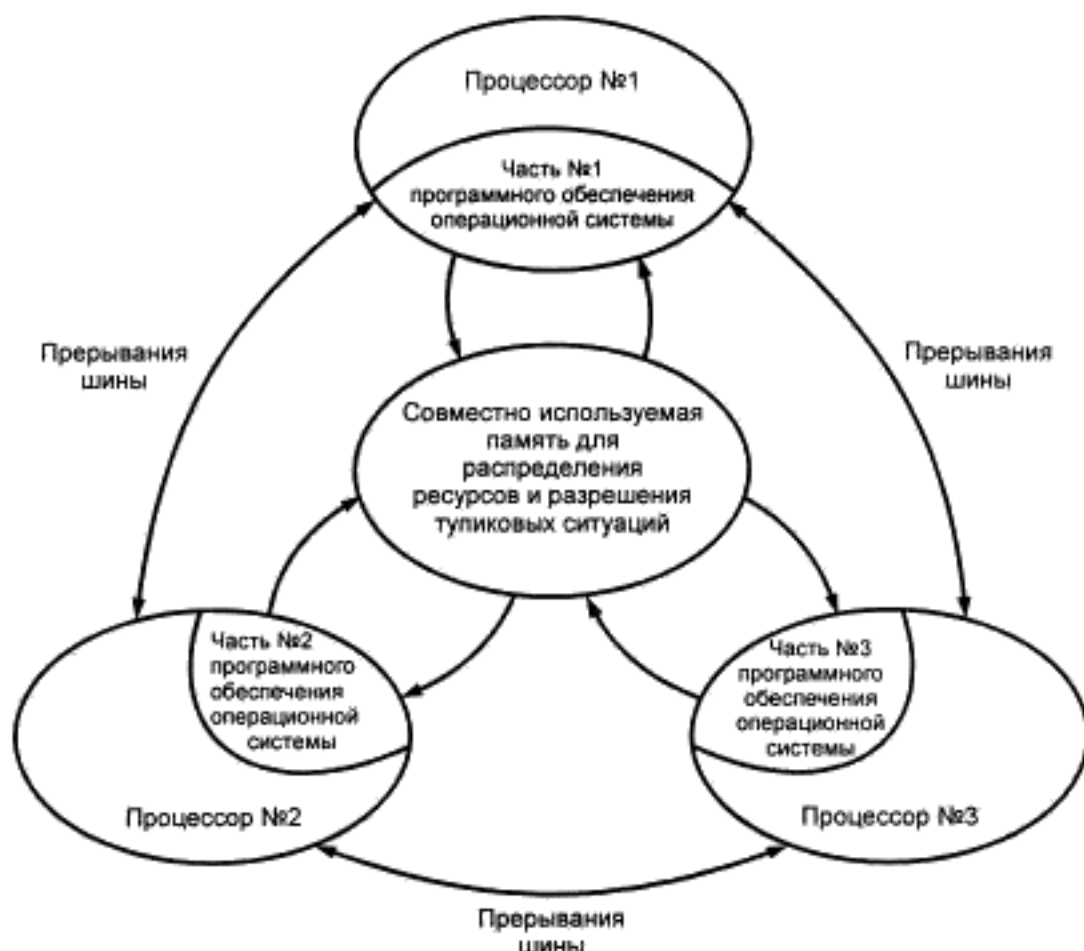
Рисунок 4.3 — Структурная схема распределенной системы прерывания
