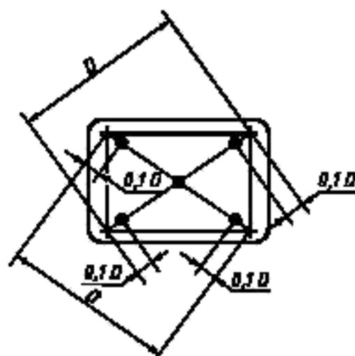
Рисунок 2 — Положение фотометрируемых участков фильтра
