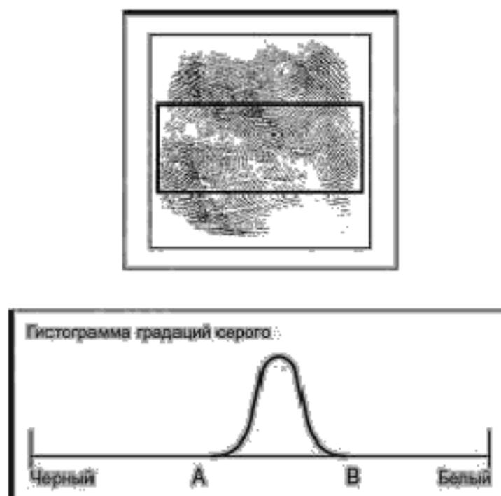
Рисунок А.1 — Определение динамического диапазона
