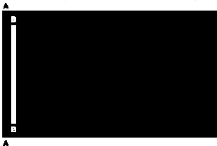
Рисунок D.1 — Мaska для статических измерений коэффициента отражения
