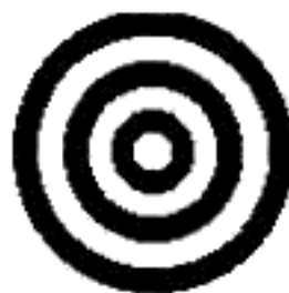
Рисунок J.3 — Типичный шаблон поиска MaxiCode, напечатанный с разрешением 12 точек/мм
